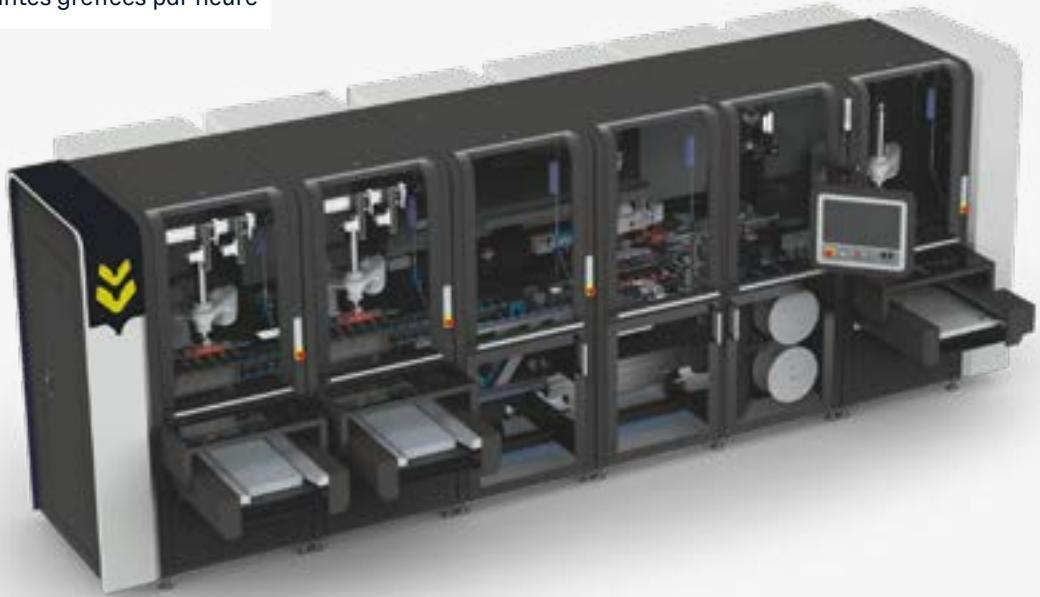
Le High-Speed Grafter est la première machine entièrement automatisée capable de greffer à la fois au-dessus et en dessous des cotylédons. Il utilise l'intelligence artificielle visuelle et la robotique pour produire jusqu'à 4 000 plants greffés par heure.
